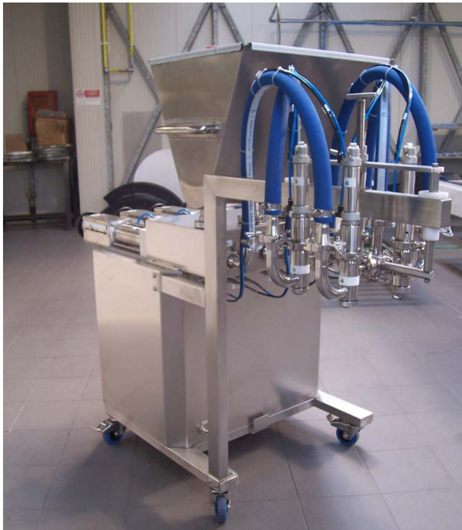
Esempio di DOSATORI MULTIPLO a 4 Example of FILLING UNITS with 4 dosing cylinders
