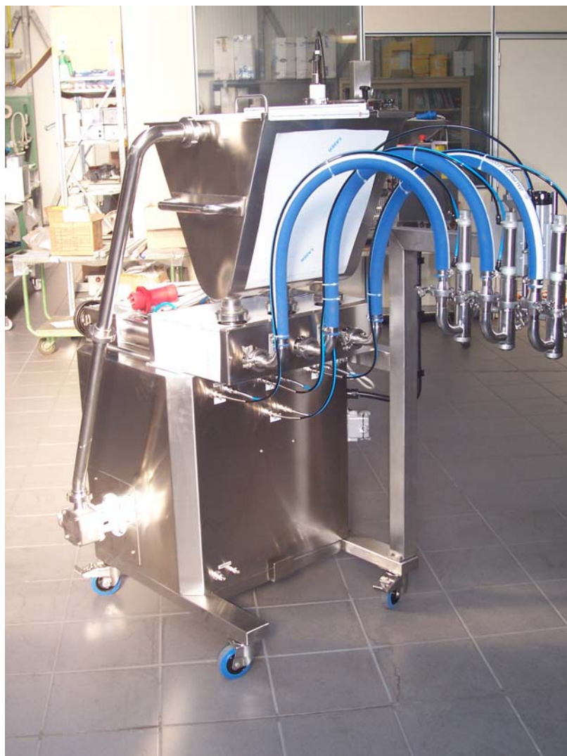
Esempio di DOSATORI MULTIPLO a 3 Example of FILLING UNITS with 3 dosing cylinders
