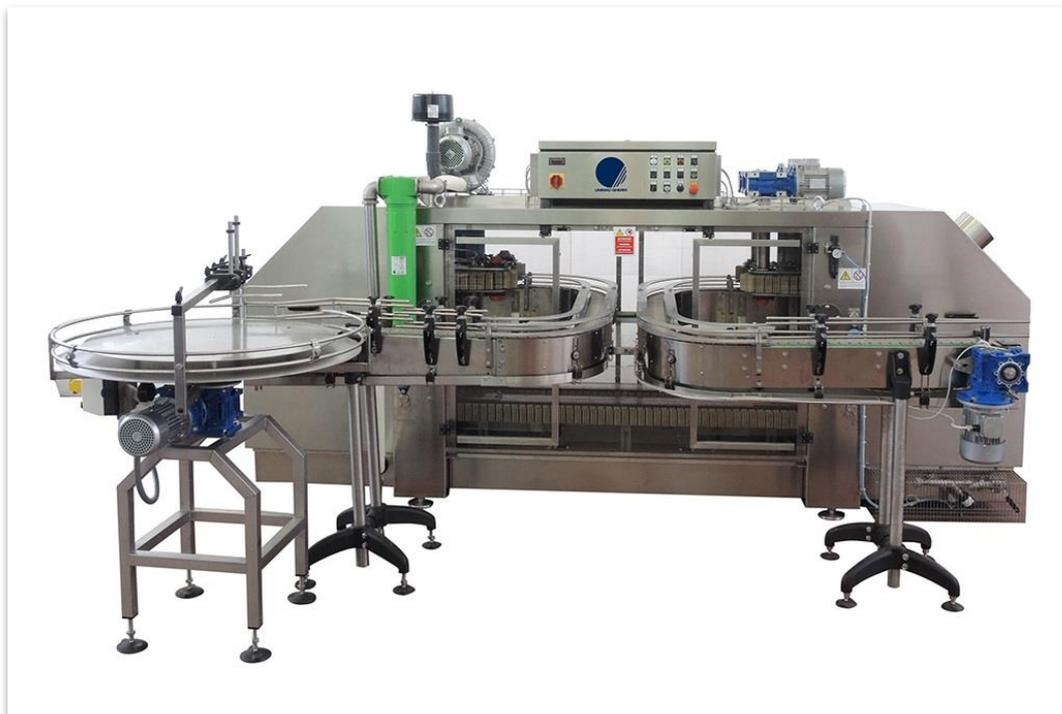
Автоматическая машина для сушки заполненных банок и бутылок, модель UG06
