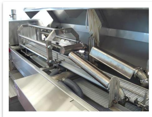
Тоннель для ополаскивания заполненных банок, модель TUN
