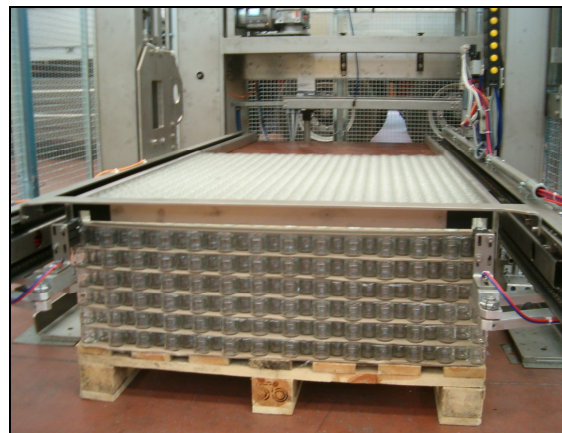
Depalletising cycle start and layer-pad pick-up by pincers Départ cycle de dépalettisation et pinces de prise intercalaires
