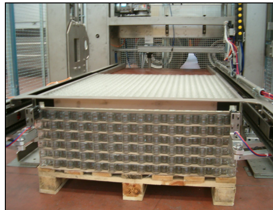
Inizio ciclo depalettizzazione e sistema di pinzatura falde Arranque ciclo de despaletizado y pinzas de toma separadores
