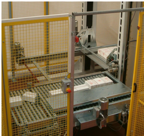
Motorised infeed module with row preformation Section motorisée en entrée avec préformation de file
